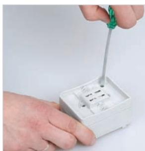
Вывернуть два винта-самореза из лицевой панели корпуса
