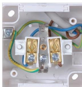
Зажимные контакты розеток удобны и позволяют надежно соединять 2 провода с сечением до 2,5 мм<sup>2</sup> одновременно.
