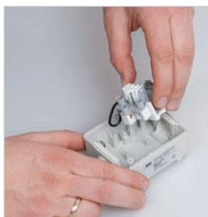
Снять верхнюю панель и механизм выключателя
